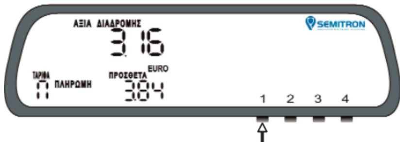
Στη θέση λειτουργίας “Πληρωμή” πατήστε το πλήκτρο 1 για να ολοκληρωθεί η μίσθωση. Το ταξίμετρο θα εκτυπώσει μια απόδειξη (αν είναι προγραμματισμένο) και θα μεταβεί στη θέση λειτουργίας “Ελεύθερο”.
