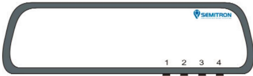
Κατά τη διάρκεια της θέσης λειτουργίας "Κλειστό" δεν υπάρχει κάποια ένδειξη και το ταξίμετρο λειτουργεί με χαμηλή κατανάλωση. Εάν το όχημα κινείται, το ταξίμετρο θα καταγράψει την απόσταση στον κατάλληλο μετρητή. Στη θέση λειτουργίας "Κλειστό" πατήστε το πλήκτρο 1 για να μεταβείτε στη θέση λειτουργίας "Ελεύθερο".
